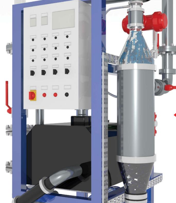
В сепараторной трубке происходит разделение сточных вод и воздуха. Воздух и сточные воды перекачиваются специальными насосами.
