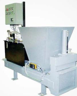
Устройство предназначено для уплотнения алюминиевых и стальных банок, путём спрессовывания их для уменьшения объёма хранения. Гидравлически управляемый уплотнитель полностью автоматический: система управления уведомляет, когда машина должна быть опустошена.
